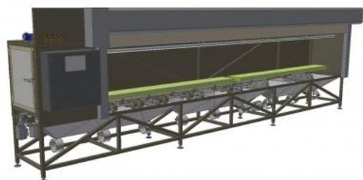
Кабинет для очистки частей строительных лесов - опор и платформ.
