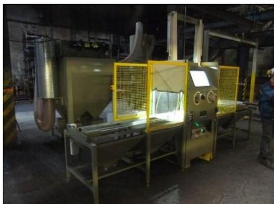
Модифицированный дробеструйный кабинет с автоматической подачей поворотного стола и открывания дверей, а также с расширенными средствами безопасности.
