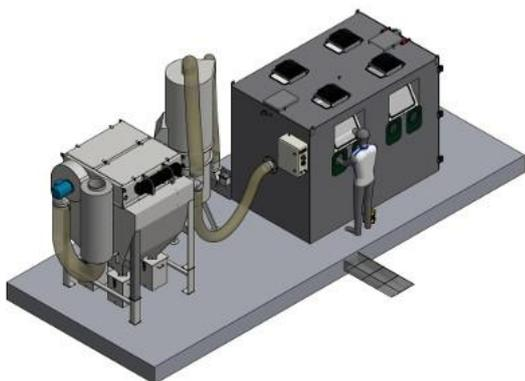
Cabine de sablage modifiée avec quatre postes de travail et retour au niveau du sol par la section M.
